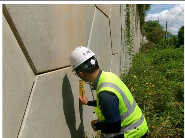
경사계를 이용한 경사도 측정
