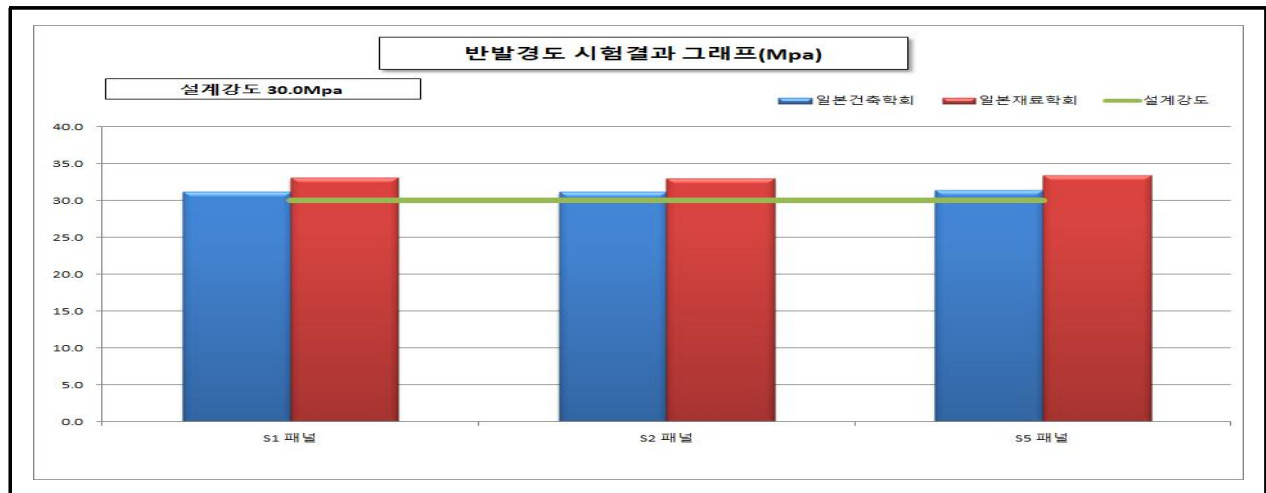
【그림 77.8】 반발경도시험 측정결과
